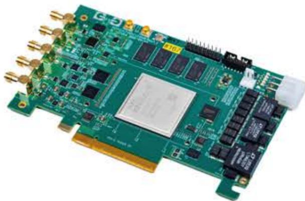
ADAQ1004采集卡具有功耗低、尺寸小、模拟输入带宽高(DC~2GHz)、具有12 bit分辨率的高速信号采集板卡。ADAQ1004采集卡支持双通道输入、最高采样率可达3GSps,该板卡可以将外部输入的信号通过衰减器、差分放大器以及低通滤波器调理后,进入ADC,实现外部输入信号与ADC输入信号之间的匹配。
